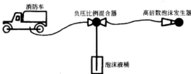
图 1 典型移动式高倍数泡沫灭火系统原理
